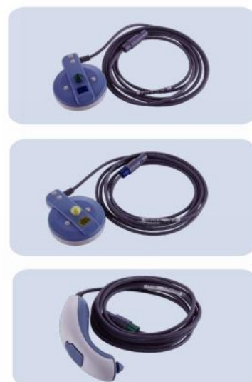
Sondas separadas: FHR, TOCO, Marcador de eventos FM
